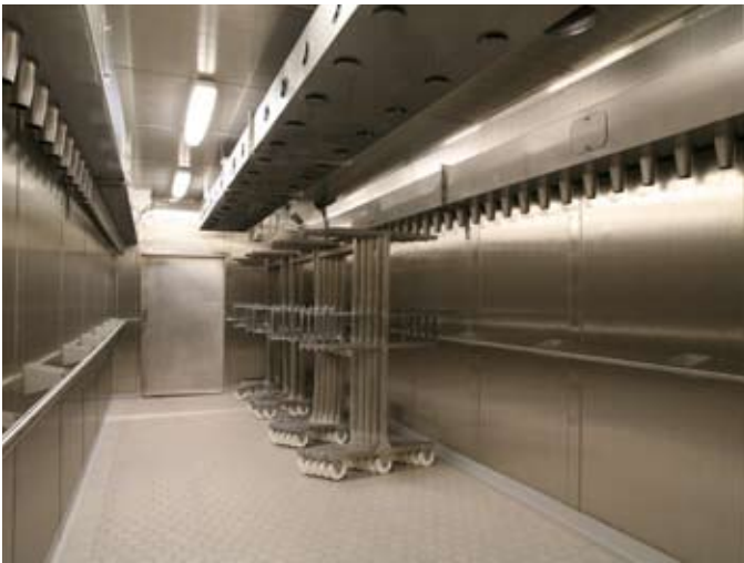
Ausführung der Rauch- und Klimaanlage Sorgo Anlagenbau, AT-9020 Klagenfurt
